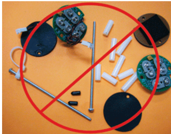
Abbildung 4 Beide Halteschrauben entfernt
